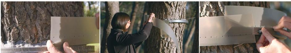
Découlez la bande de protection de la mousse en commençant par l'extrémité biseauté. Présentez la collerette, **trous d'évacuation vers le bas, côté lisse à l'intérieur.** Collez la collerette à partir de cette extrémité, c'est-à-dire la partie haute du plancher.
