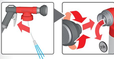
**Handventil betätigen, Düse wird rückgespült**
